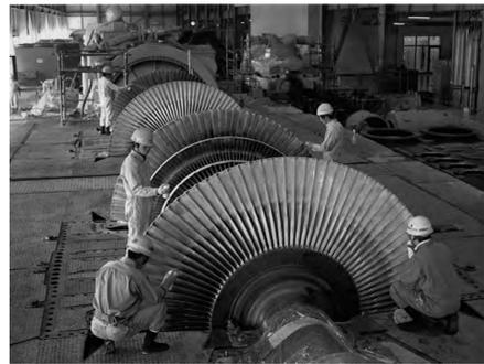
九州電力豊前発電所2号機低圧タービン翼PT検査の様子
